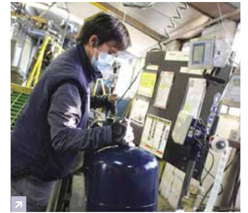
Après la peinture, la monitrice tare la bouteille : elle appose une pastille qui indique la masse de celle-ci une fois qu'elle sera remplie de gaz.
