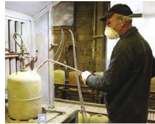
Une fois vidées des résidus de gaz et passées au four pour enlever la peinture, les bouteilles endommagées sont débosselées.
