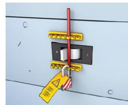
Condamnation d'un disjoncteur
