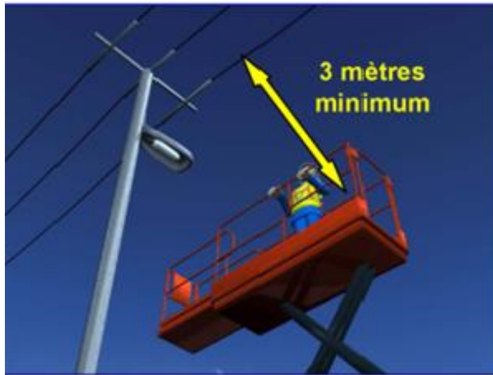
3 mètres si moins de 50 000 Volts
